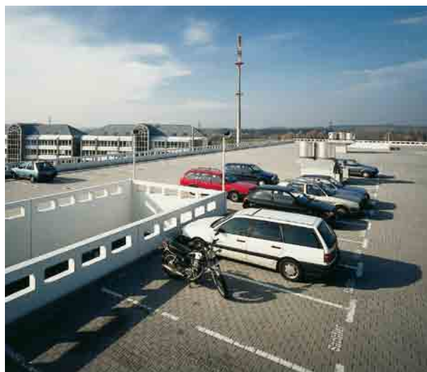
Joonis 52 » Parkimismaja, kus on kasutatud servasoonega raudbetoon-sillutuskive
